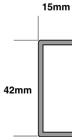
Zwei dieser Stahlwinkel werden als Verbindung der beiden äusseren Seitenruder benötigt.
